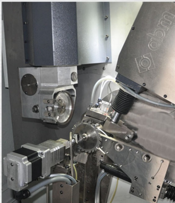
Función automática para saltar dientes rotos por el dedo indexador inteligente
