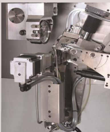
Controle automático de torque, da distância e da espessura da lâmina por fixação micropasso.
