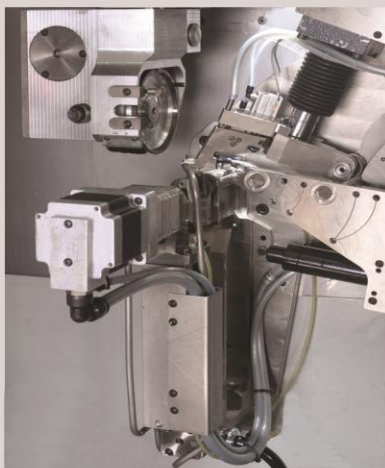
Control automático de torque, distancia y del espesor de la hoja por sujeción micropaso.
