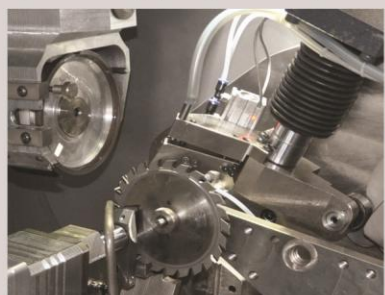
Función automática para saltar dientes rotos y paso variable por el dedo indexador inteligente
