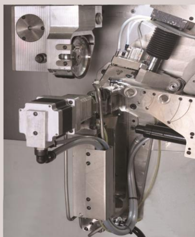
Управление усилием, расстоянием и толщиной зажима пилы микрошаговым двигателем
