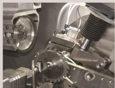
Автоматический пропуск сломанных зубьев и интеллектуальный толкатель для различного шага зуба. Опциональная пневматическая система для заточки подрезных пил в сборе
