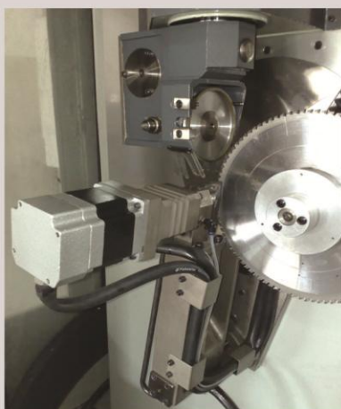
Regolamento automatico del spessore della carne, della lontananza e del momento torcente
