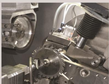
Salto automatico dei denti rotti con la graffia intelligente, e la spinta automatica dei denti Sistema pneumatico opzionale per affilare il tracciatore in due pezzi in una sola volta
