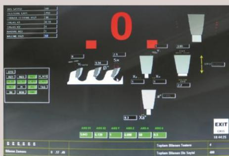
Pantalla de parámetro Rectificadora de Flancos Control CNC de avance y ajuste automático del ángulo de biselado
