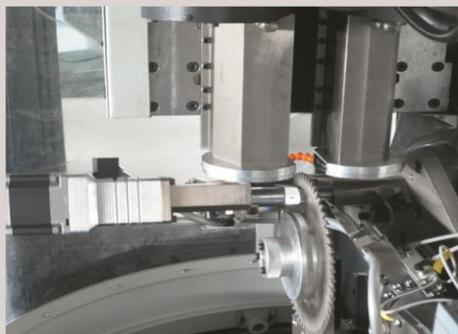
Rectificado suave de hojas estroboscópicas gracias al sistema basado en el motor. Sistema dedo inteligente patentado proporciona una indexación de dientes sin tocar el cuerpo y sin dañar la sierra.
