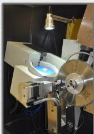
Controle da distância torque e controle automático da espessura da serra pela fixação microstep
