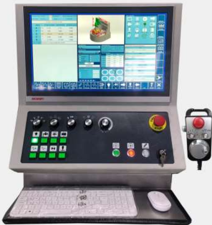
Pantalla táctil 21,5"LED con PC industrial
