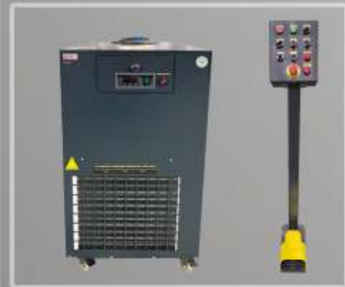
Manuel Aktivasyon Pedalı ve İndüksiyon Soğutma Ünitesi (Manual Activation Pedal and Induction Cooling Unit)
