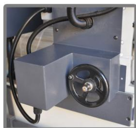
Управление съёмом при заточке карбидных ножей с помощью двигателя
