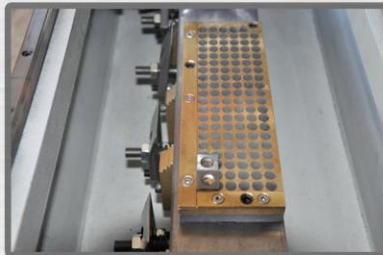
Söküp-takılan HSS takma uçlar için manyetik aparatı.
