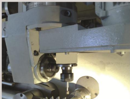
Opcional dente côncavo para afiação de face côncava de serras circulares.
