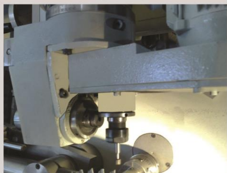
Оptionальное устройство для затачивания дупловидной формы зуба
