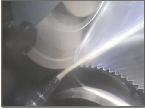
Ø200mm CBN Taşı ile HSS Daire Testere Bileme
