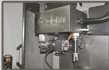
Lazer Ölçüm Sistemi (Otomatik çap ve diş sayısı ölçümü)
