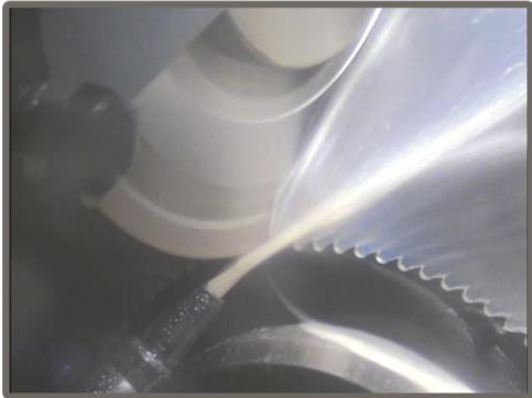
Afiação de Serra Circular HSS com rebolo CBN Ø200mm
