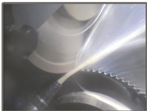
Заточка дисковой пилы HSS Ø200 мм кругом CBN
