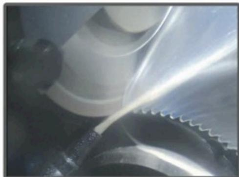
Affilamento delle lame circolari HSS con la mola CBN di Ø200 mm
