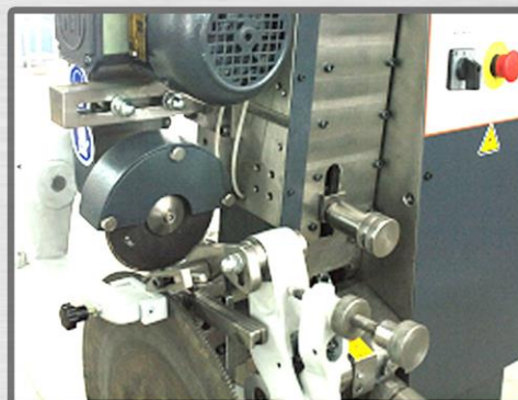
Chanfragem manual direita/esquerda de serras circulares HSS
