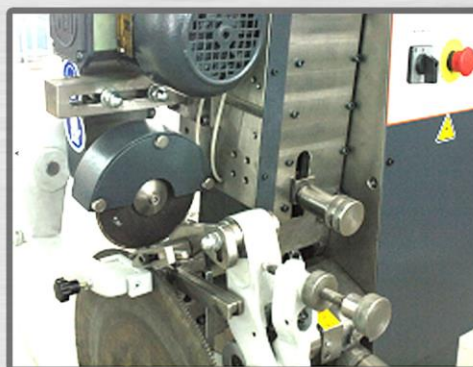
Скос фаски влево/вправо на зубьях дисковых пил HSS вручную
