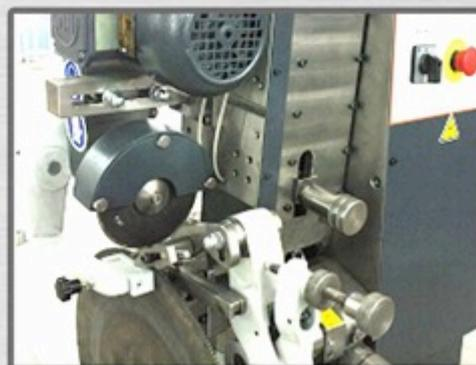
Frattura manuale dei lati destra-sinistra delle lame circolari HSS
