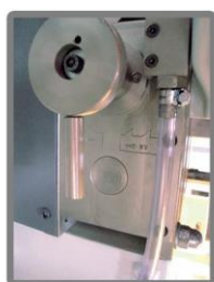
Cam-control do formato do dente
