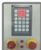
Pannello di controllo 24V
