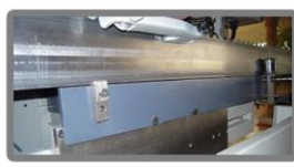
Механизм вертикального перемещения пилы с помощью двигателя
