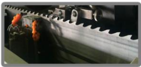
Motor Kontrollü Şerit Testere Aşağı-Yukarı Hareketi
