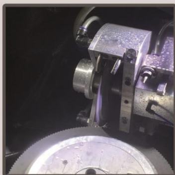
Автоматическое снятие фаски справа и слева
