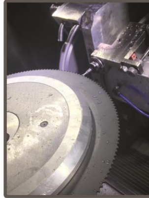
Kalınlık Kontrolü için Dahili Ölçme Probu
