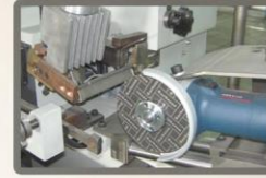
Kesme motoruyla manuel olarak kesilen stellite çubuk.
