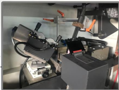
Coupe automatique de la tige Stellite par meuleuse d'angle.
