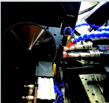
Meulage lisse des lames grâce à le système de serrage. Le système breveté du doigt intelligent permet d'indexer la lame sans toucher le corps et sans l'endommager.
