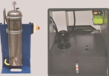
Merkezi yağlama sistemi, opsiyonel yağ mikro filtre sistemi ve hava mikro filtre sistemi
