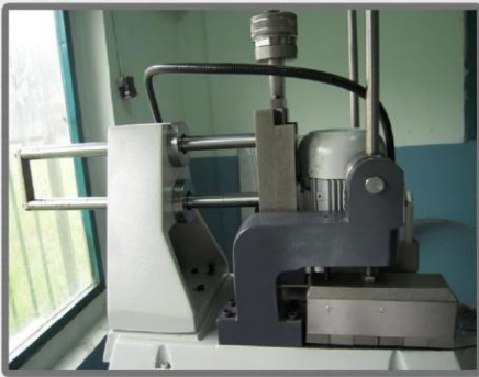
Welding burr remover head riding on hardened spindles Cabezal de solda montado en ejes endurecidos Cabeçote de solda montado em eixos endurecidos
