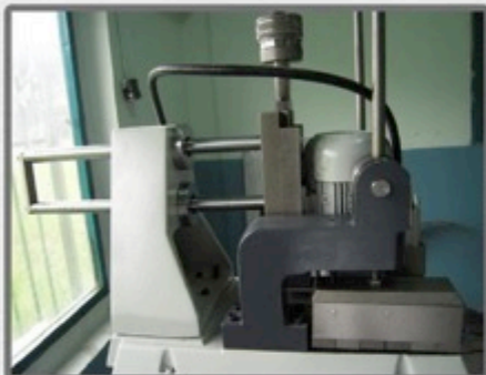
Testa della rimozione della bava in movimento sugli alberi temprati Welding burr remover head riding on hardened spindles Перемещение зачистной головки по закаленным шпинделям
