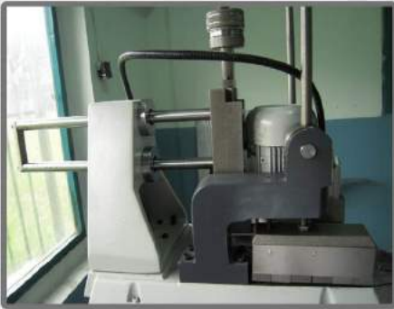
Welding burr remover head riding on hardened spindles Cabezal de solda montado en ejes endurecidos Tete d'élimination des bavures de soudage montée sur des broches trempées
