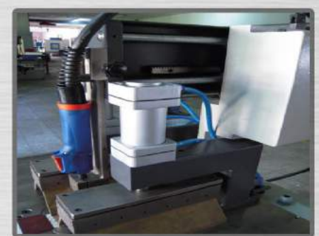
Welding head riding on hardened spindles Cabezal de soldadura en ejes endurecido Tete de soudage montée sur des broches trempées
