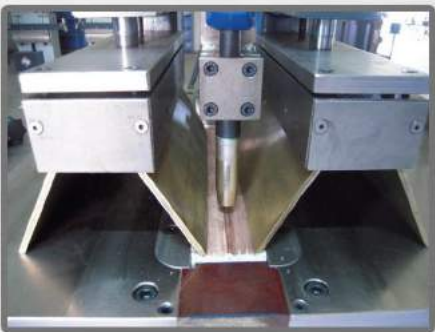
Controlled annealing process during welding on the same welding table Proceso de recocido controlado durante la soldadura en la misma mesa Processus de recuit contrôlé pendant le soudage sur la meme table de soudage
