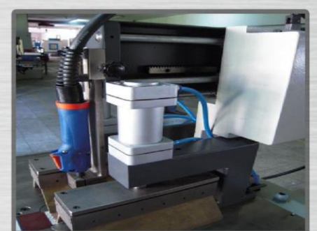
Welding head riding on hardened spindles Cabezal de soldadura en ejes endurecido Cabeçote de soldagem em eixo endurecido
