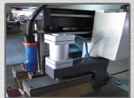
Sertleştirilmiş miller üzerinde hareket eden kaynak kafası Welding head riding on hardened spindles Перемещение сварочной головки на закаленных шпинделях
