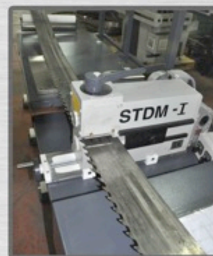
Correzione delle lame sensibili a nastro per eliminare dalle distorsioni possibili in lavorazione
