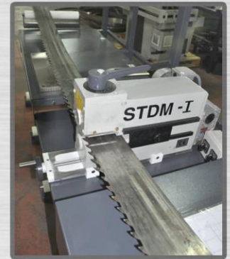
Çalışma esnasında ortaya çıkabilecek olası sapmaların önüne geçebilmek için hassas şerit testere düzeltmesi.
