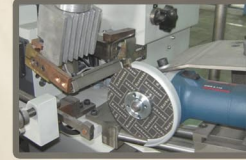
Découpe de tige stellite par meuleuse d'angle
