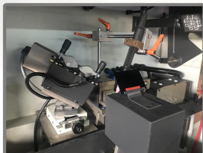
Découpe de tige stellite automatique par meuleuse d'angle
