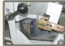
Tempera automatica, saldatura manuale delle punte di stellite
